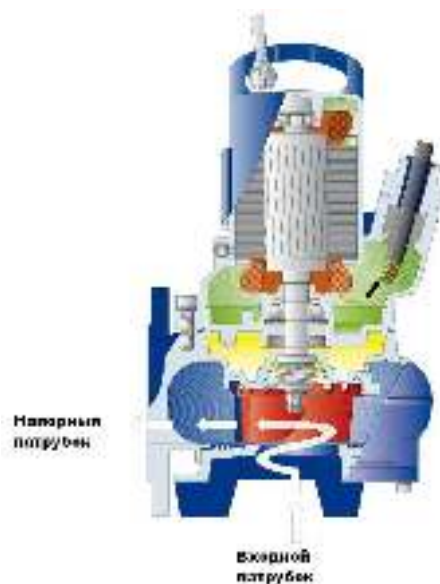
Рис. 9 Схема расположения патрубков насоса
