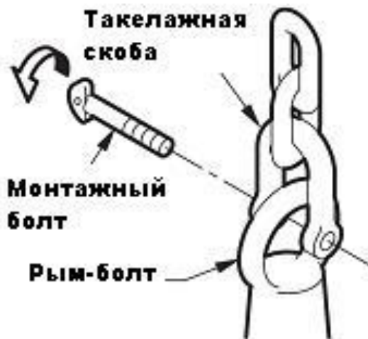
Рис. 3 Использование такелажных скоб
